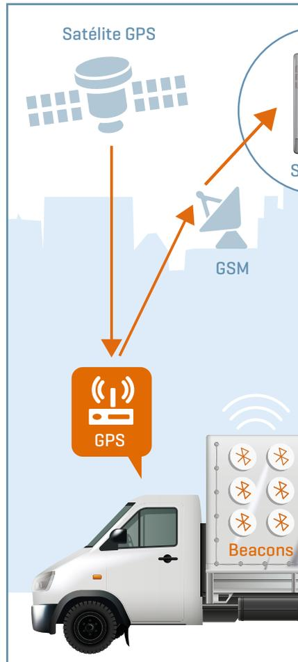
Las balizas son reconocidas por el dispositivo GPS del vehículo. Este envía esta información a través de la red móvil a nuestro servidor. Puede consultar el perfil de movimiento de las balizas en el software.
